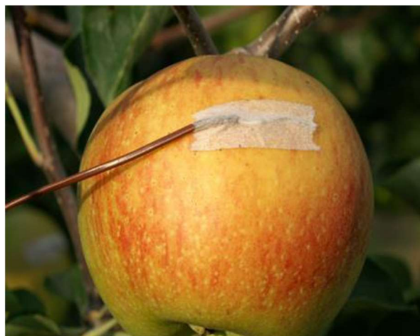
図 3-11 果実の表面温度変化をセンサーで測定し、日焼け発生程度に及ぼす影響を調査 出典) 長野県における気候変動の影響と適応策、2021年3月
