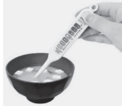
良くかき混ぜた味噌汁の中にセンサー部(先端部の半分位が目安)が十分に浸るまで入れていただくだけで、塩分濃度を測定できます。
